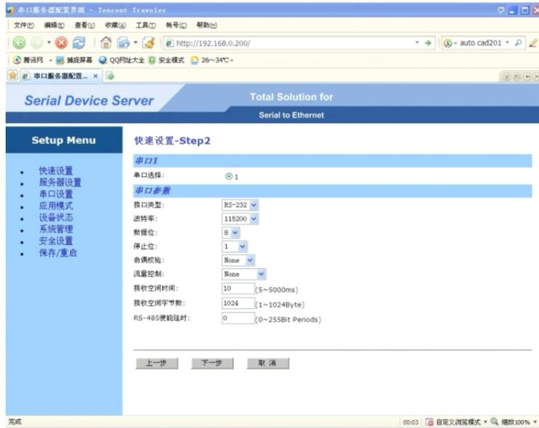
此步骤中根据您使用的是几口的串口服务器，您可以在上面“串口选择”处选择相应的串口设置，如：您使用的是 HK-8102D，那么您在串口选择“1”可以对第一个串口进行设置，选择“2”，可以对第二个串口进行设置。当然，由于 HK-8102D 中两个串口是独立的，所以这两个串口您可以根据需要设置成不同的工作方式和不同的串口参数。如：1 可以设置成 232 方式，2 设置成 485 方式等等。
