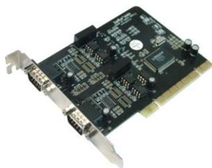
HighTek 1002B 两串口扩展卡, 是通过 PCI 总线扩展 2 个串行 RS232 通道, 接口方式通过跳线设置, 可以使您的计算机与 RS232 接口的设备如仪器、仪表、门禁机等方便的连接; 产品支持 32 位/64 位 PCI 总线, 具备 PNP(Plug and Play)即插即用功能, 无须设置中断与 IO 地址 (由 PCI BIOS 自动分配); 另外每个端口提供 16 个字节的收/发 FIFO 缓存, 串行口 RS232 全部具备浪涌保护功能以及光电隔离功能。
